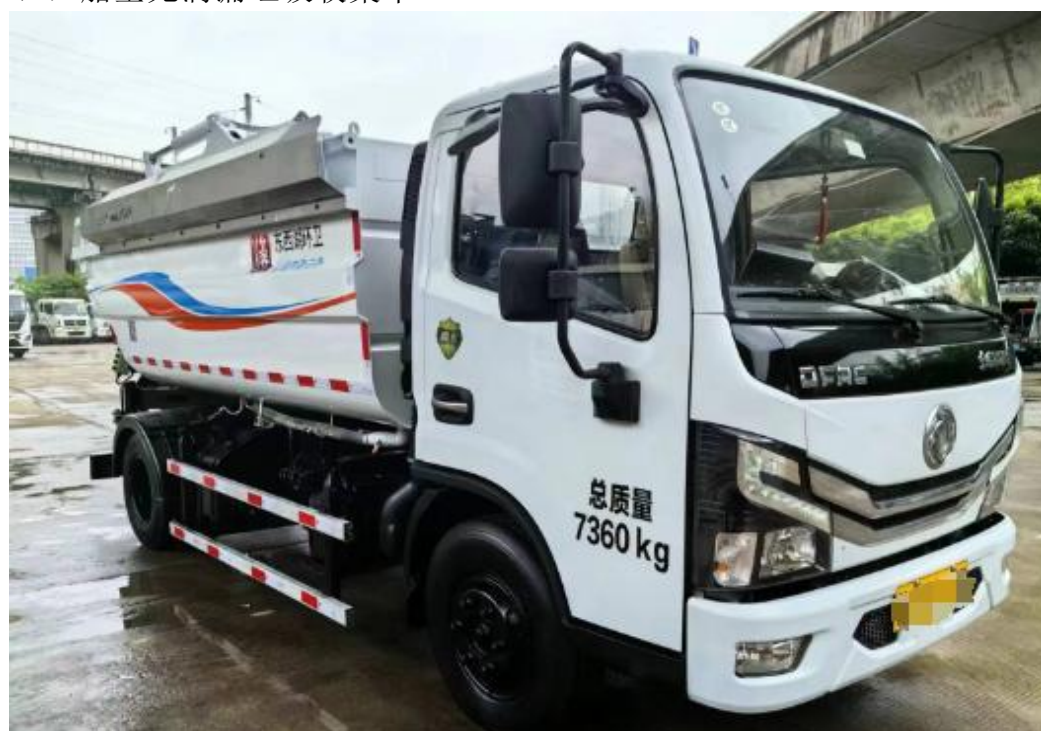
(5) 船型无滴漏垃圾收集车
