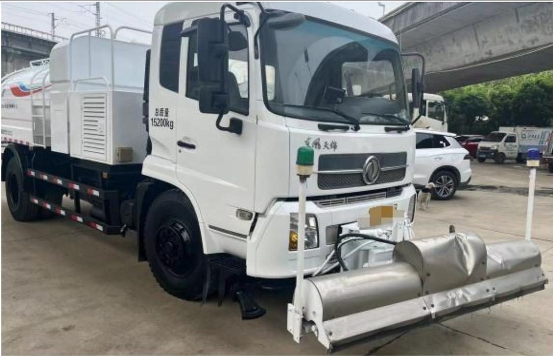
(4) 路面养护车 (小型高压冲洗车)
