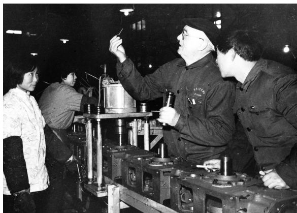
1985年1月，格里希在装配车间用磁铁棒和手电筒检查正在装配的柴油机
