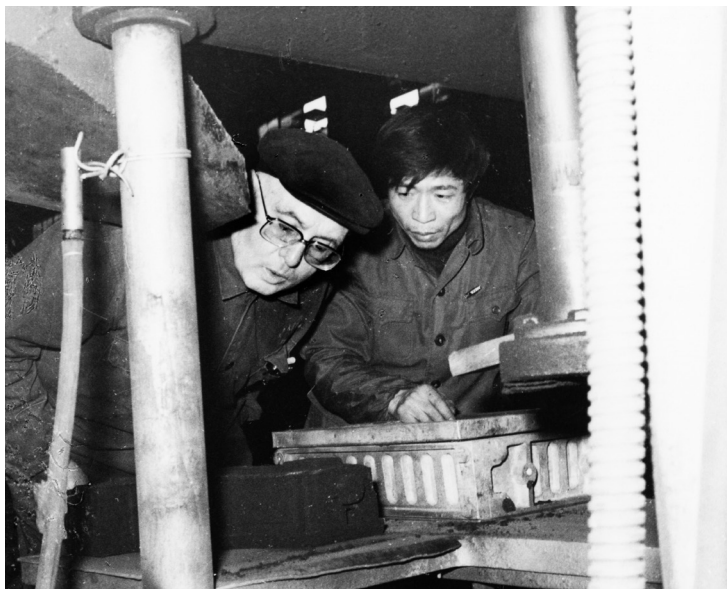
1985年4月，格里希在铸造车间和工人一起查看机体型砂质量
