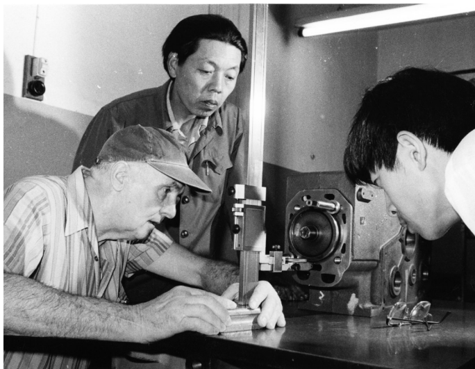
1986年9月，格里希在检验科专用工作间，检验机体零件上缸盖连接螺孔的坐标尺寸
